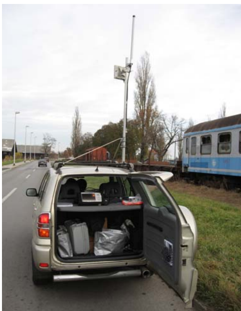
Slika 2. Testno vozilo tvrtke MICRO-LINK d.o.o. tijekom mjerenja na WiMAX mrežama
